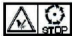
При работе оборудования существует вероятность ампутации конечностей. Запрещается находиться в опасной зоне при работе оборудования.
